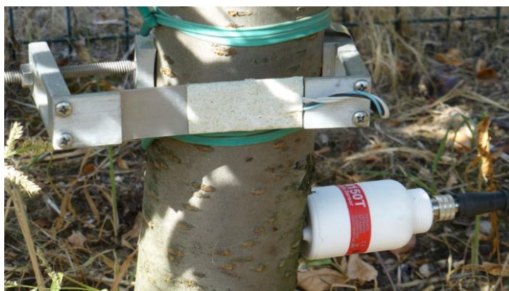
Fig. 13. Sistemul de monitorizare a micro-oscilațiilor diametrului trunchiului pomilor - detaliu de instalare a dendrometrului DEX 100 (Dynamax, Inc. Dendrometers)
