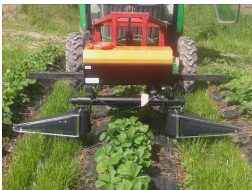
Fig. 23. Echipamente de aplicare ULV a erbicidelor biologice la căpșun și arbuștii fructiferi (Sursa: Mantis Weed Control)
