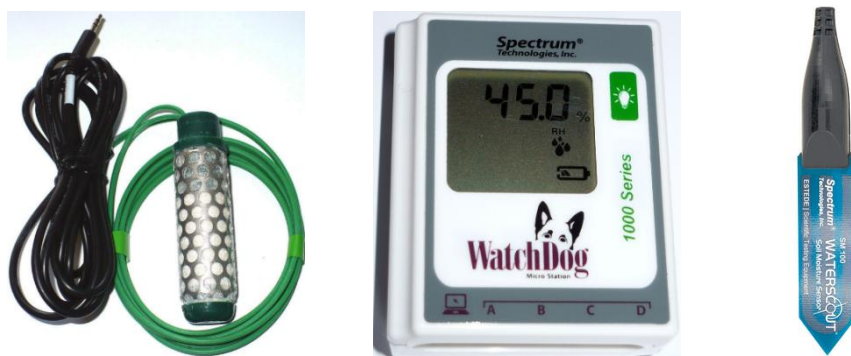
Fig. 11. Senzorul de potențial al apei din sol 6450 Watermark Soil Moisture Sensor și înregistratorul WatchDog 1400 Micro Station - w/4 External Ports, Spectrum Technologies, Inc.
